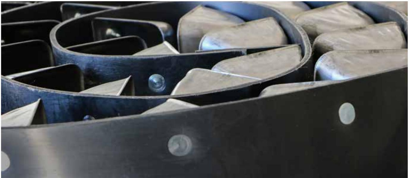
Mit Elevatoren, auch Becherwerke genannt, können Schüttgüter (feinkörnig) bis zu einem Steigungswinkel von 90° gefördert werden. Es ist ohne Weiteres möglich, Achsabstände (Hubhöhen) von über 100 m zu erreichen.
