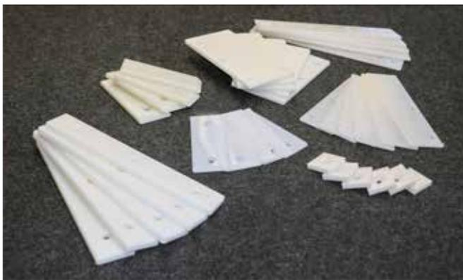
Kunststoff-Fräsen ist eine zerspanende Bearbeitung. Das Material wird maschinell abgetragen, um so ein nach Kundenwunsch vollendetes Produkt zu erschaffen. Mittels Computersteuerung und modernen 3-Achs-Fräsen, 4-Achs-Fräsen und 5-Achs-Fräsen sind keine Grenzen gesetzt. Zu unseren Absatzmärkten zählen hauptsächlich Maschinenbau-, Medizin- und Lebensmittelindustrie.
